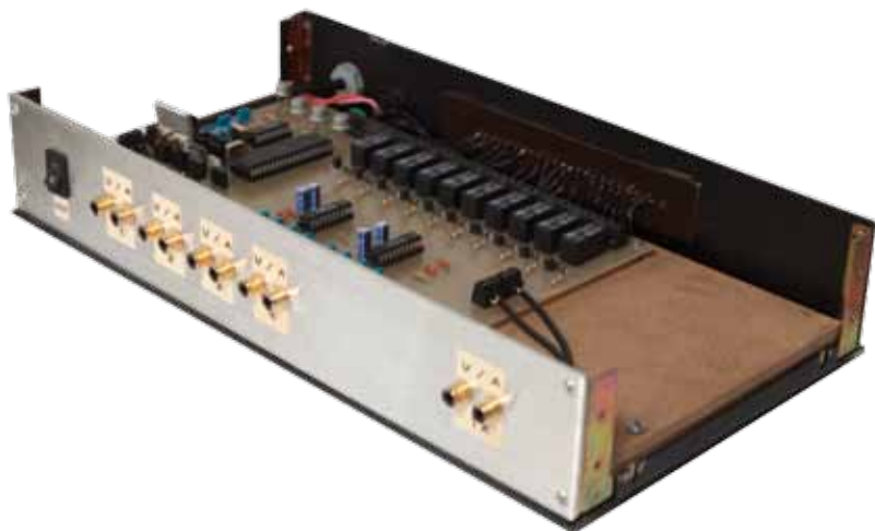
Konzola za priklop več kamer ter daljinsko kontrolo ATV oddajnika, prav tako plod znanja Uroša Krajnerja S57WOT
